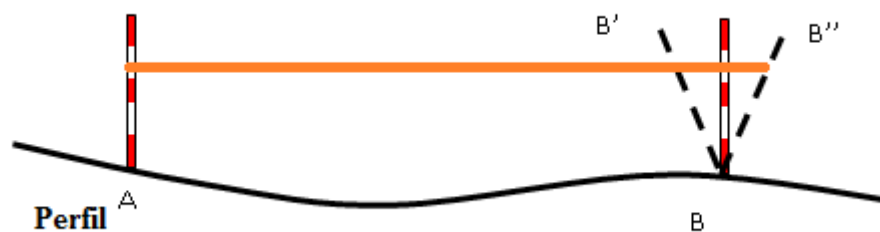
Figura 7 – Falta de verticalidade da baliza (Véras, 2003).
