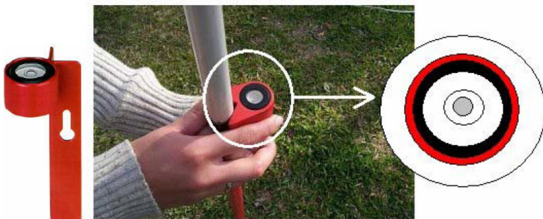
Figura 23 – Nível de cantoneira acoplado a uma baliza (Luis Veiga, 2007).
