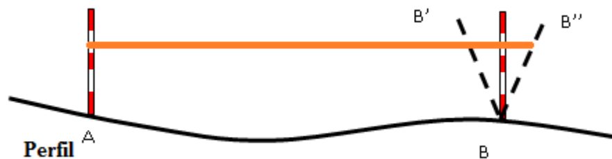
Figura 10 - Erro pela falta de verticalidade da baliza.
